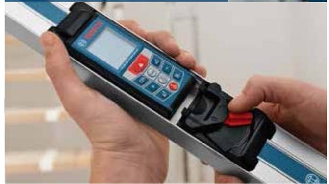
El conjunto perfecto para medición de distancia e inclinación. El primer medidor de distancia del mundo que se transforma en un nivel digital profesional cuando se lo combina con la regla R 60.
