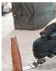
Cortes en tuberías plásticas, perfiles metálicos y materiales no ferrosos.
